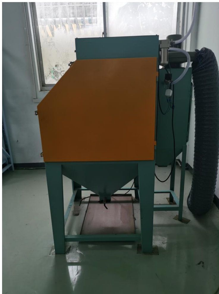
图 3-2 喷砂废气收集处理设施图
