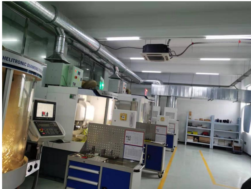
图 3-1 机加工废气收集情况图
